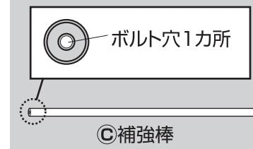
**補足** P.2に記載の組立方法「2 補強棒を仮留めします」は以下のように組み立てます。
